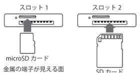
金属の端子が見える面を下にして挿入してください。
